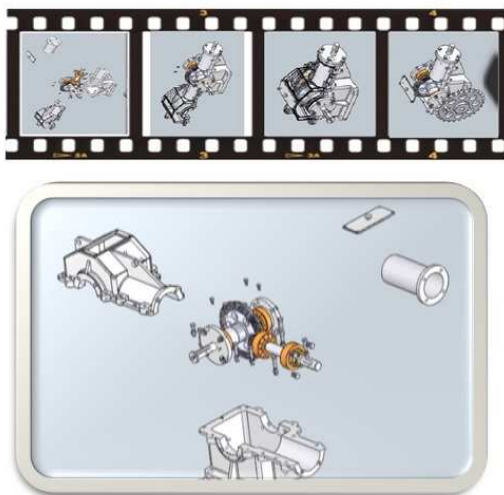
Рис. 2. Кадры из учебного видеоролика «Сборка редуктора»
