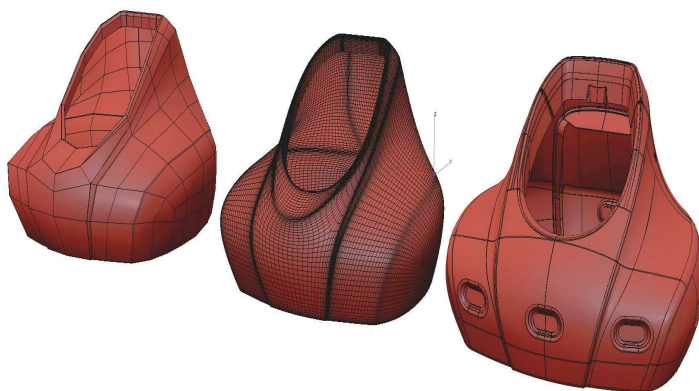
Рис. 4. Слева направо: низкополигональная модель, высокополигональная модель, параметрическая модель
